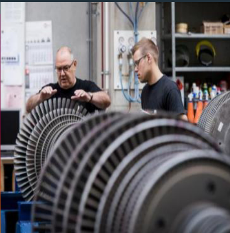
S. turbine repair
